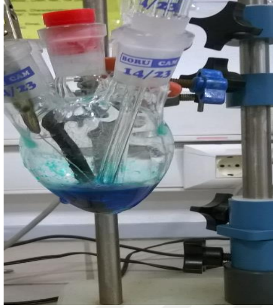
Şekil 2.2 Zn_2Pc_2 'nin elektrokimyasal analizi esnasında kalp tipi hücre görüntüsü.
